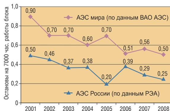
*Динамика автоматических остановов реакторов из критического состояния АЭС России и АЭС мира*
